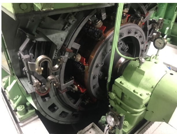
Vänstra bilden: Änden på en likströmgenerator med skyddskåpor borttagna.
