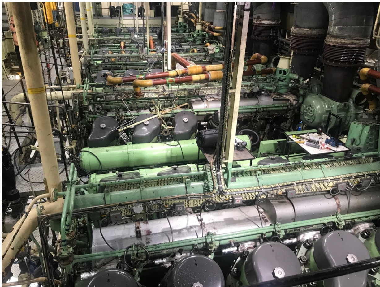
Bilden visar det från borde till borde välfyllda maskinrummet med sina fem huvudmaskiner, var och en drivande en dubbel likströmgenerator. Totalt alltså tio generatorer för drift av de fyra propellrarna.
